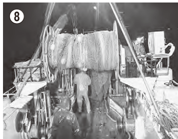
⑧ 網はネットローラーで巻き上げていきます
