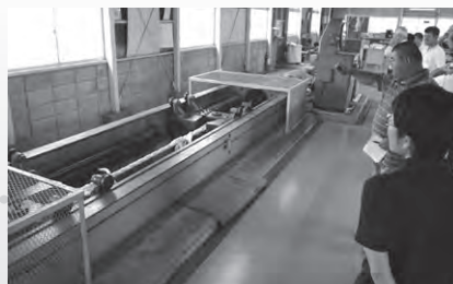
ロープ切断試験の様子
